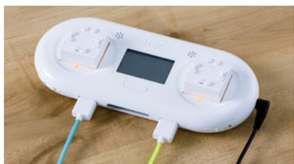
「toio™リング」と電源を接続し、キューブを充電します
