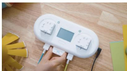
「カートリッジ」を差した「toio™コンソール」とキューブの電源を入れます
