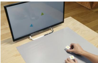
「toio™ コア キューブ (以降、キューブ)」は、専用マットの上で瞬時に自分の位置を把握し、2台同士が**お互いの位置も正確に把握**。マットに印刷された目に見えない特殊パターンを読み取ってセンサー (光学センサー) で認識し、**絶対位置を検出**します。他にも、姿勢検出や高性能モーターなど、**先端テクノロジーをたっぷり搭載！**
