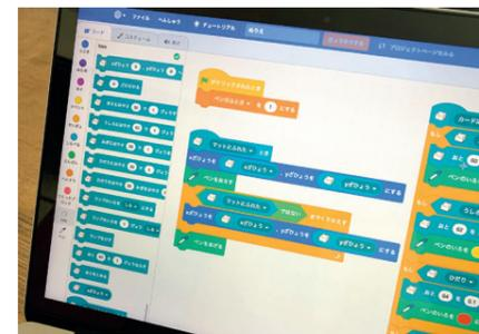
ブロックを並べるだけの**ビジュアルプログラミング**「toio Do」(P13) で、「toio™ コア キューブ」をタブレットやパソコンから動かしましょう! 小学校の授業でも使われる手軽な方式で、座標を使ったロボット制御や、お絵かきがたのしめます。
