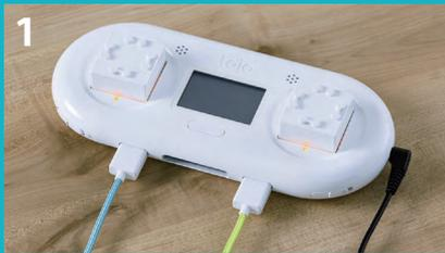
1 「toio™リング」と電源を接続し、キューブを充電します
