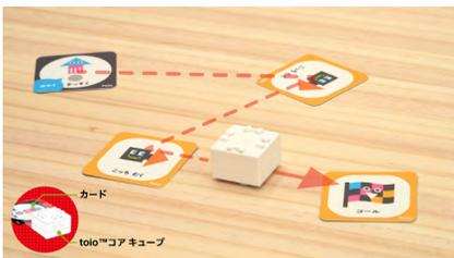
toioの通り道にカードを置くだけ。キューブがカードの絵柄を読み取り指示通りに動きます。
